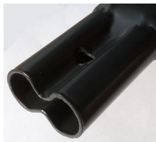
Внешний вид трубы после обжата
